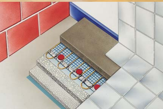
Die Heizmatte der Fußboden-Direktheizung ist identisch mit der Fußboden-Speicherheizung.
